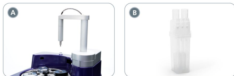
Ilustración 3. (A) Brazo robótico y (B) estante de puntas con filtro, RoboSep™. Tenga en cuenta que, antes del uso, hay que quitar la tapa del estante de puntas con filtro, RoboSep™.
