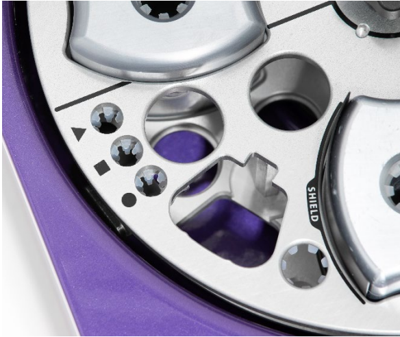
Ilustración 6. Empaquetaduras del carrusel. Empaquetaduras en las posiciones de vial de reactivo y tubo de muestra.
