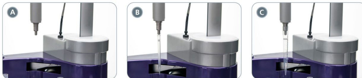
Ilustración 4. Cabezal de puntas en el brazo robótico. El cabezal de puntas (A) antes de coger una punta y después de coger una punta de 1 mL (B) y una punta de 5 mL (C) desechables.
