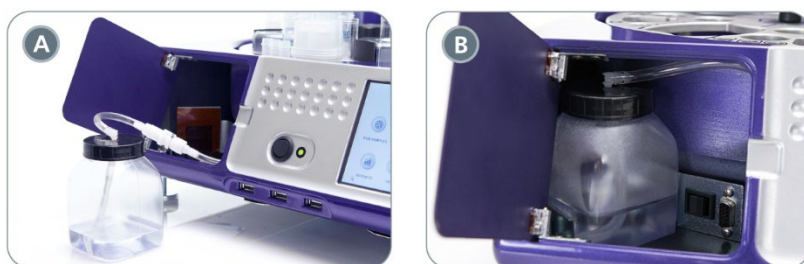
Ilustración 14. Sistema hidráulico. Frasco hidráulico y liberación rápida (A) fuera y (B) dentro del instrumento.
