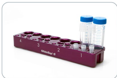
Ilustración 21. Estante de servicio RoboSep™. Tubos y viales colocados en el estante antes de cargar el carrusel. Los números de cuadrante se especifican en el lateral del estante.
