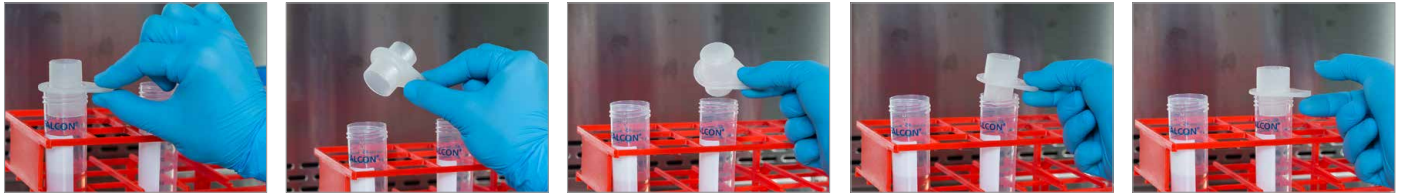
图3. 将可翻转的过滤网翻转到新的锥形管上。箭头此时向下。
